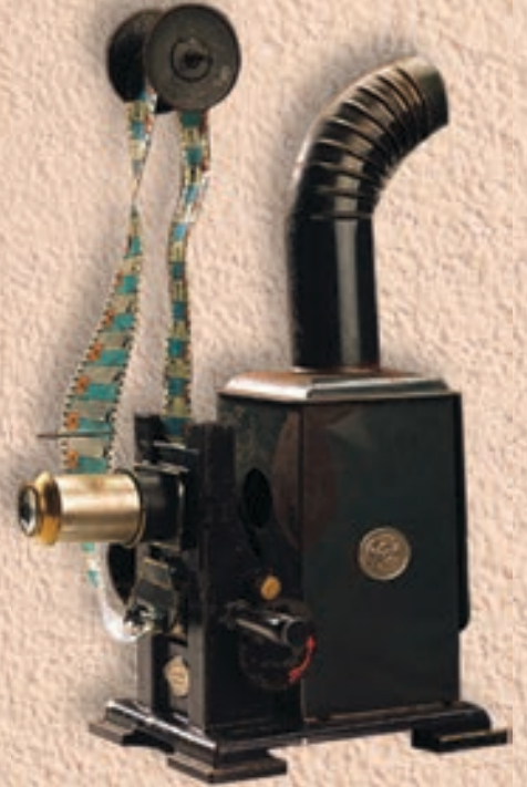
Sinematograf Magic Lantern (Büyülü fener: Gaz lambası ile çalışan slayt projektörü): Müzemizde sergilenmekte olan örnek Ernst Plank şirketi tarafından, 100 yıl önce Almanya'da üretilmiştir
