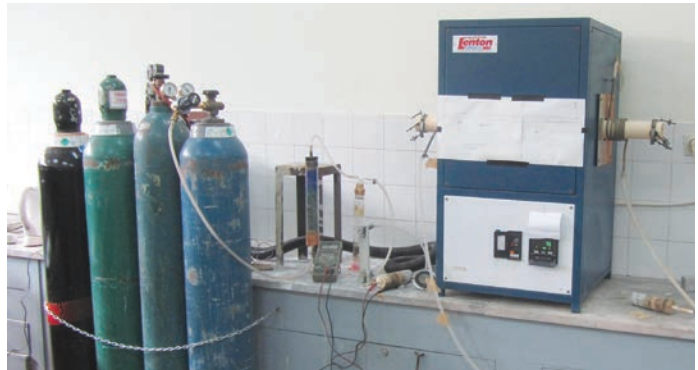
Kalsinasyon fırını, Atılım Üniversitesi Üretim Metalurjisi Laboratuvarı (solda) ve Yüksek sıcaklık fırını (Önindirgeme ve ergitme aşamaları), ODTÜ (sağda)
