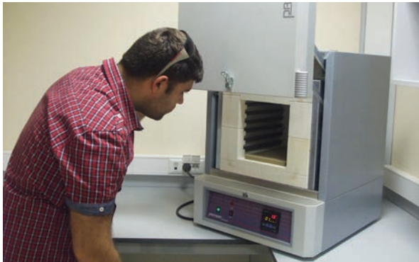
Kalsinasyon fırını, Atılım Üniversitesi Üretim Metalurjisi Laboratuvarı (solda) ve Yüksek sıcaklık fırını (Önindirgeme ve ergitme aşamaları), ODTÜ (sağda)
