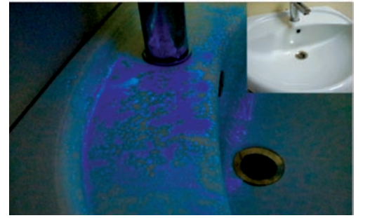
Şekil 3. Küçük resim gün ışığında temiz olduğu düşünülen bir lavabo. Büyük resim ise laboratuvarlarımızda sentezlenen luminol-tipi bir maddenin görünmeyen kan lekelerinde kullanımı; kanın olduğu bölgeler karanlıkta mavi renkte ışımaya başlıyor.
